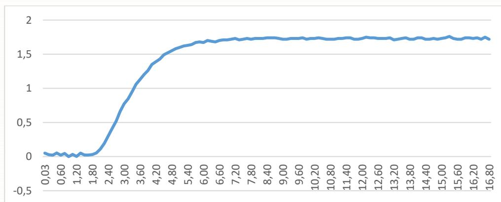
Sabendo-se que o degrau dado foi de 20% a 60% e o valor do processo se estabiliza em 1,7, utilizando a Equação (9), o valor do ganho encontrado é de 0.0425 sendo que o valor gerado pelo software Control Station® foi 0.0422, como pode ser visto abaixo. Sabendo-se que, através da Equação (10), a constante de tempo ( $\tau$ ) é igual ao tempo levado para se atingir 63,2% de resposta estabilizada, logo, pela análise do gráfico plotado no Excel, o valor de  $\tau$  é
