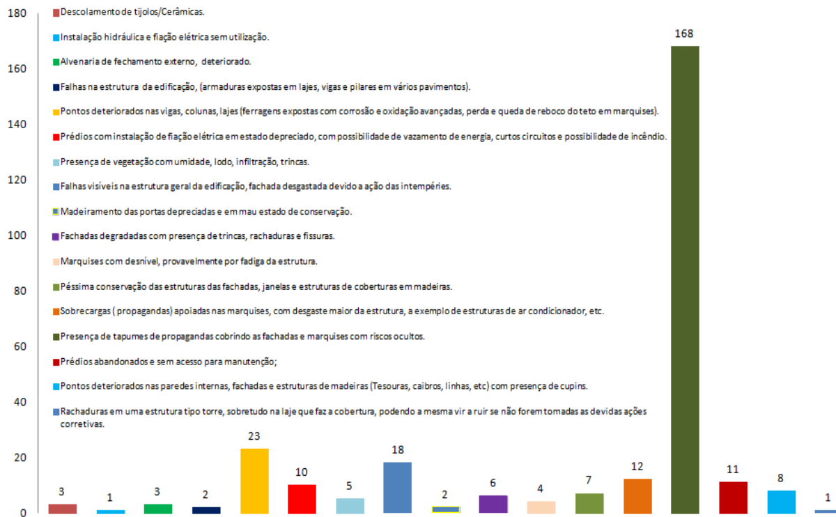
Figura 4- Levantamento das principais patologias encontradas nos Edifícios visitados em Campina Grande-PB.
