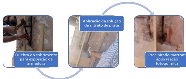
Figura 4 - Esquema de execução do ensaio de cloretos.
