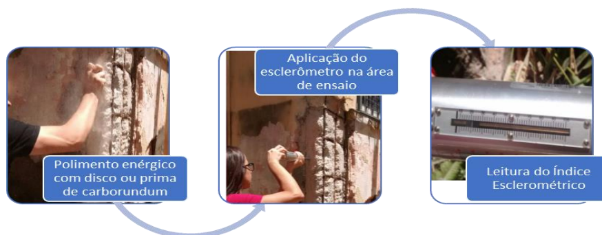
Figura 5: Esquema de execução do ensaio de esclerometria.
