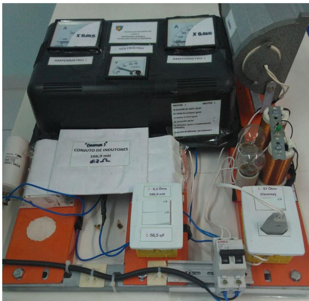
Em seguida, montamos o circuito colocando nossas cargas em paralelo, cada uma seguida de um interruptor para seccionar a passagem de corrente em seu respectivo dispositivo conforme diagrama abaixo.
