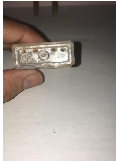
Figura 2 - Orifícios da cuba menor, para que o gel entre em contato com a solução tampão.
