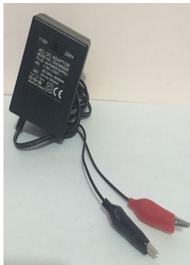
Figura 3 - Fonte de energia, reutilizada de um telefone fixo
