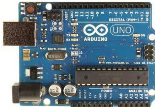
**Figura 1. Placa Arduino Uno R3.**
