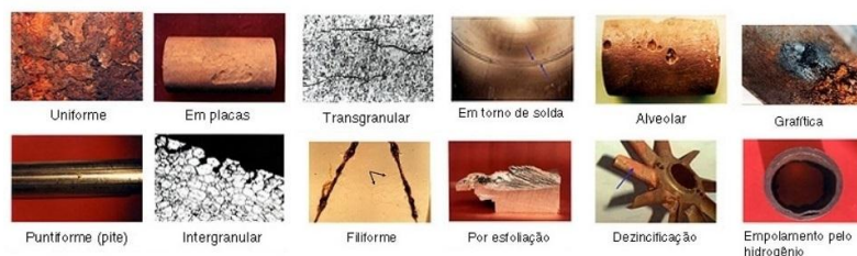
Figura 2 – Tipos de Corrosão
