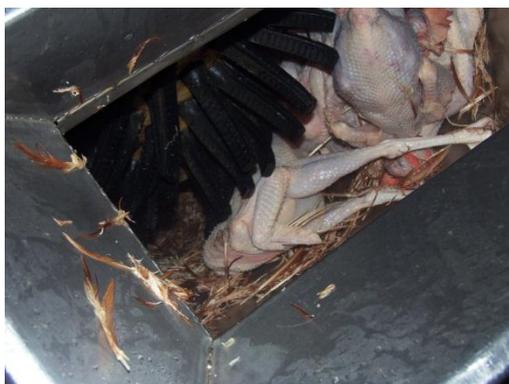
Figura 4. Processo de depenagem das aves. Fonte: Própria
