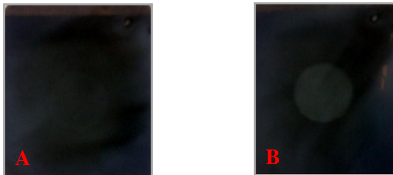
Figura 5 – Radiografias dos produtos analisados: A – HAp pura; B – Hap + 20% de Nb 2 O 5
