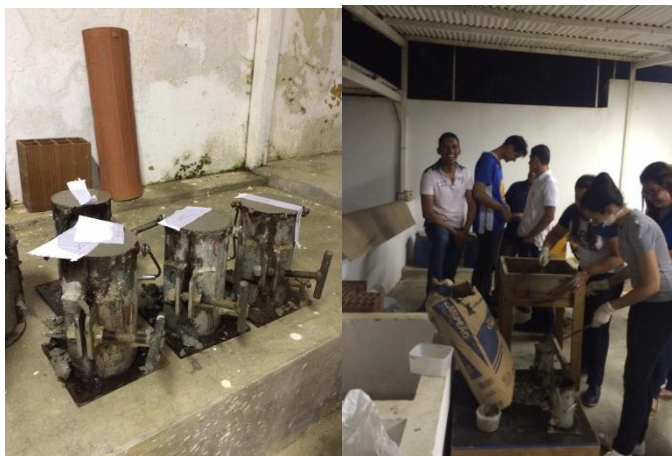
Figura 2: Moldagem dos corpos de prova, etapa do desenvolvimento de pesquisa em novos materiais do curso de arquitetura da FACISA
