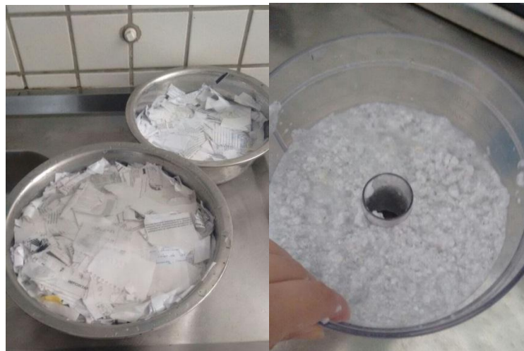
Figura 1: Obtenção da pasta de papel e gesso em pesquisa com novos materiais no curso de arquitetura da FACISA
