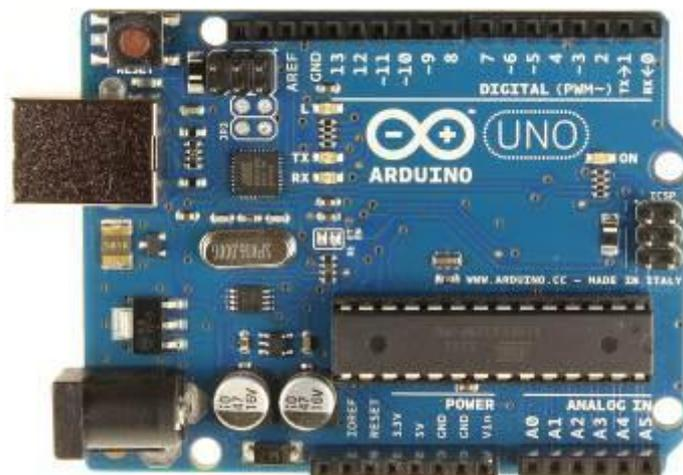
**Figura 2. Placa Arduino Uno R3.**
