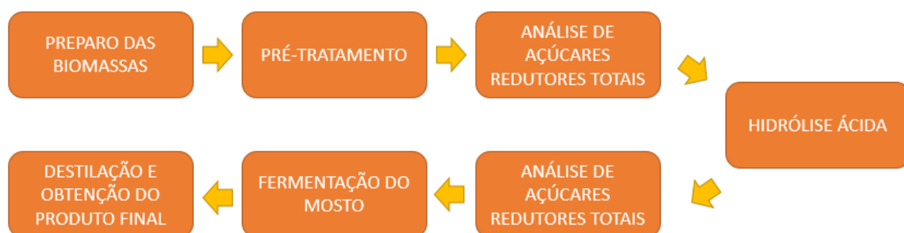
Figura 2. Cadeia Produtiva do Bioetanol de Segunda Geração em Laboratório.
