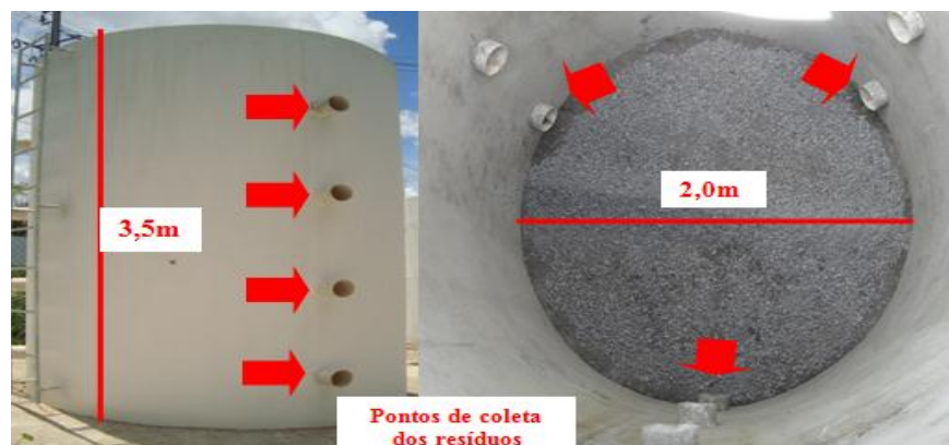
Figura 1 – Lisímetro construído na UFCG.
