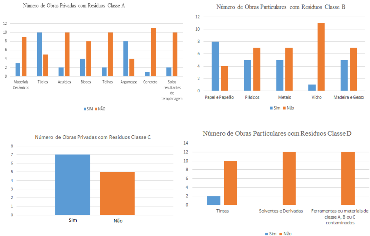
Figura 2: Dados para obras particulares (a) presença dos resíduos da classe A, (b) resíduos classe B; (c) resíduos classe C e (d) resíduos classe D.
