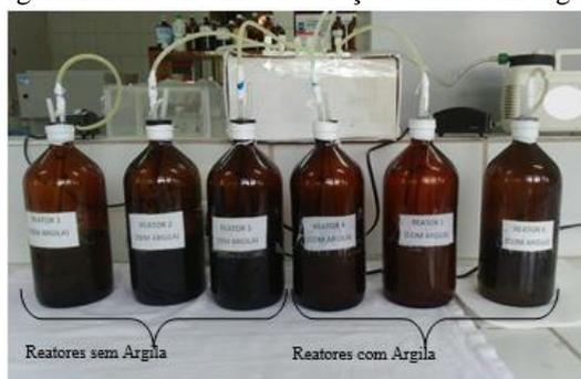
O monitoramento do sistema experimental foi realizado por meio dos seguintes fatores: tempo de aeração de 6 horas, vazão de ar de  $2 \text{ L}\cdot\text{min}^{-1}$  e difusão com jato de ar.
