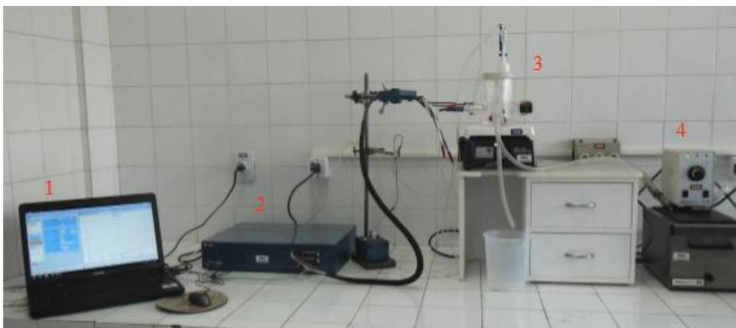
A Figura 6 é a ampliação da imagem 3 da Figura 5, a qual ilustra a célula eletroquímica utilizada no experimento de Rp, têm-se o eletrodo de referência calomelano, o contra-eletrodo de platina e o eletrodo de trabalho (placas de Pb) imersos em solução eletrolítica de  $\text{H}_2\text{SO}_4$  1N.
