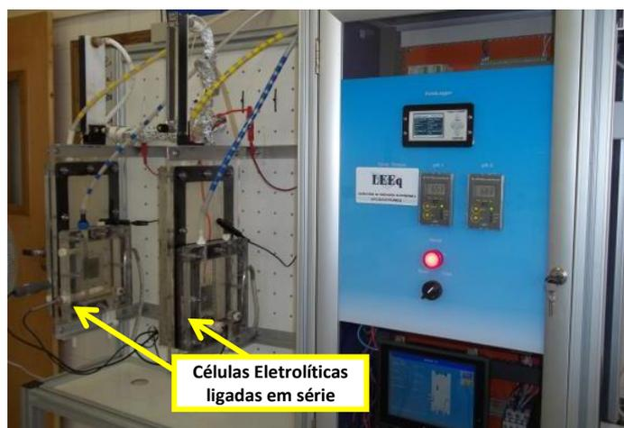
Figura 2. Sistema experimental para eletrólise da salmoura
