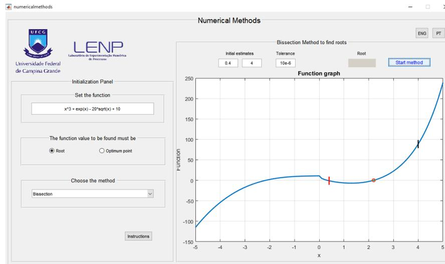
A mesma raiz ( $x = 2,1995$ ) pode ser encontrada após 21 iterações. Conclui-se que para as estimativas iniciais adotadas, e mesma tolerância ( $tol = 10^{-6}$ ), o método de Newton-Raphson apresenta uma melhor convergência.
