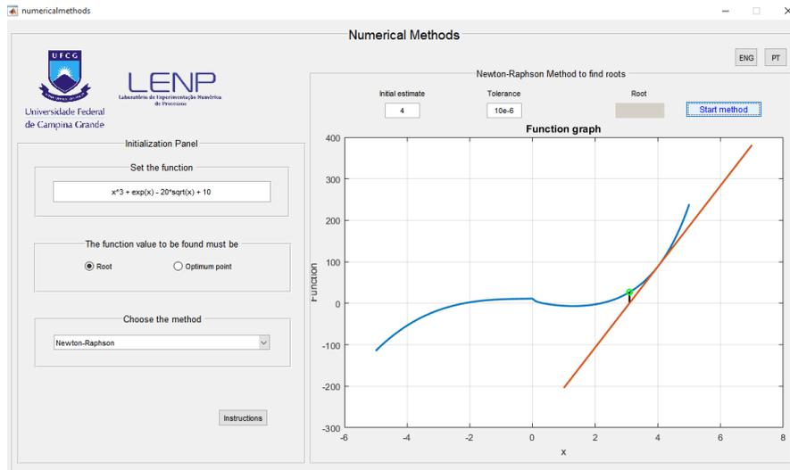
Após seis interações, uma das raízes da função foi encontrada ( $x = 2,1995$ ), com este valor sendo mostrado na GUI através de um *display* (Root), Figura 5.
