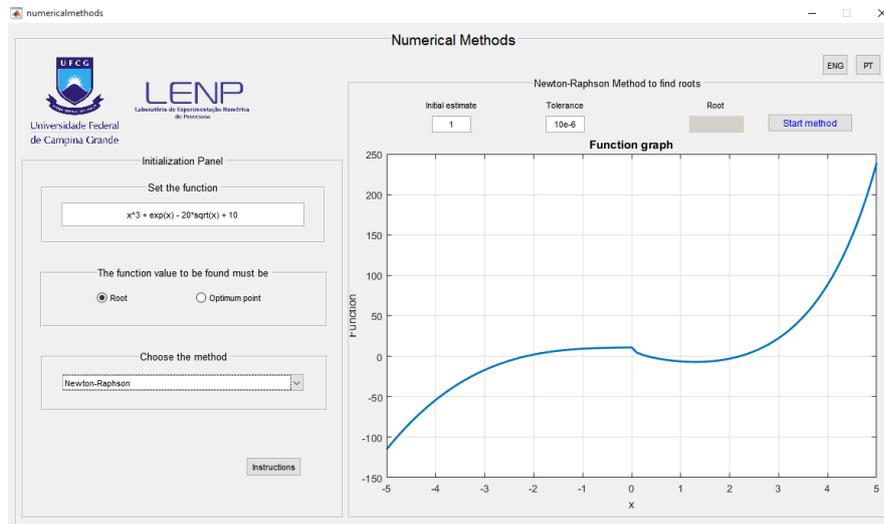
Após inserção da função analisada, a mesma é gerada graficamente, permitindo a visualização de raízes e pontos ótimos. Nesse ponto, tem-se a opção para escolha da funcionalidade da ferramenta (determinação de raízes ou ponto ótimo), bem como o método que será utilizado. De acordo com cada metodologia escolhida, Equações 1 a 7, caixas de texto específicas serão apresentadas. Para exemplificar, a função abaixo foi utilizada, Equação 8.
