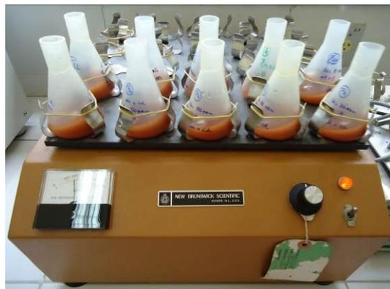
**Figura 3.** Equipamento *shaker* utilizado na realização dos ensaios de banho finito.
