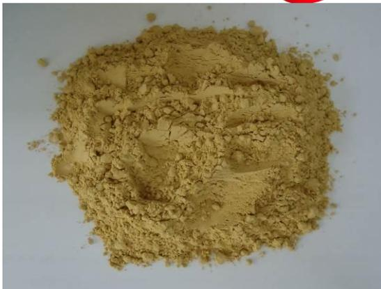
**Figura 2.** Argila Brasgel natural utilizada na remoção de metais pesados.
