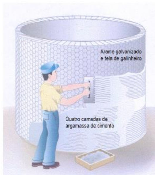
Figura 1: cisterna de concreto com tela e arame.
