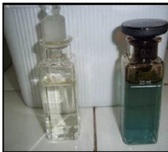
Figura 02 – Amostras em cubetas prontas para leitura- O azul forte demonstra grande concentração de enxofre
