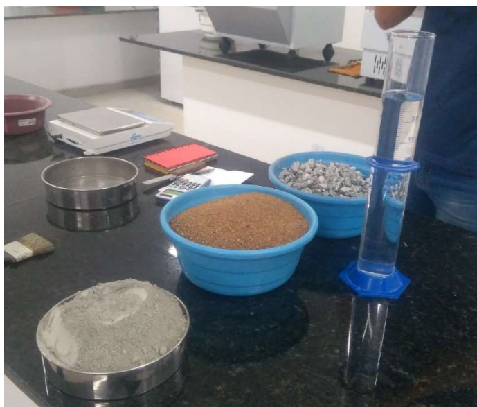
Figura 3 - Preparação da mistura de concreto com as proporções do traço Fonte: Próprio autor (2018)
