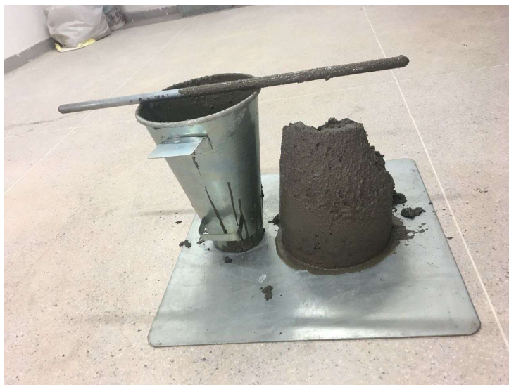
Figura 2 - Execução do Slump test para verificação do traço
