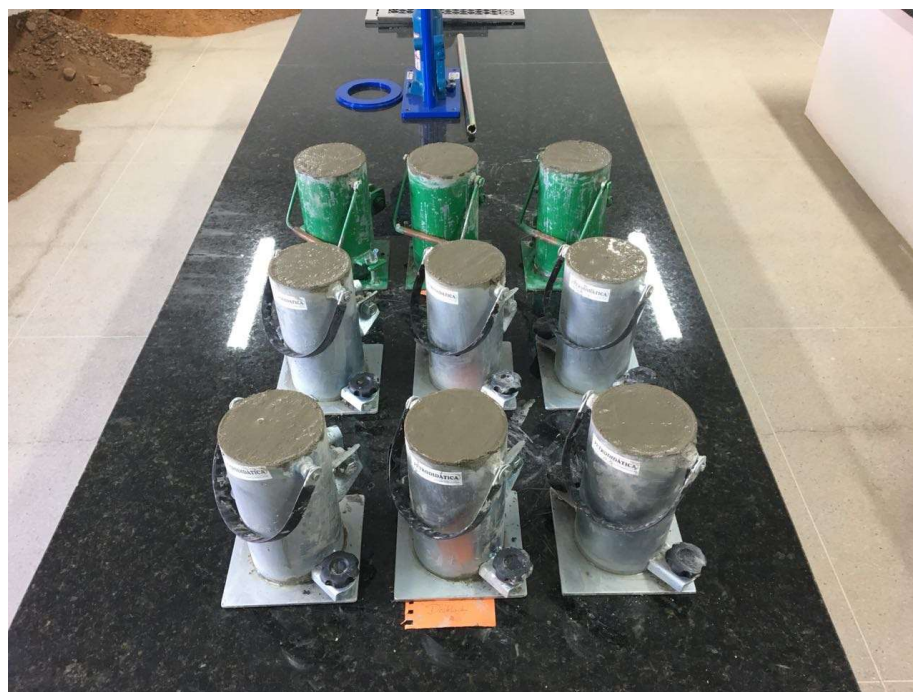
Figura 4 - Moldagem dos corpos de prova de concreto com as diferentes águas Fonte: Próprio autor (2018)
