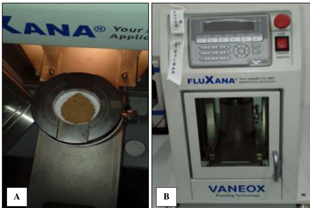
Figura 3A. Amostras de solo trituradas e passadas em peneiras de 100 MESH, antes da prensagem, numa proporção (1:1) de 2,5g de Ácido Bórico para cada 2,5g de solo; Figura 3B. Equipamento modelo FLUXANA® da marca VANEON Pressing Technology, do Laboratório de Mineralogia do INSA.
