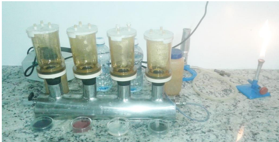
Figura 1: Processo de filtração a vácuo para análise microbiológica de água.
