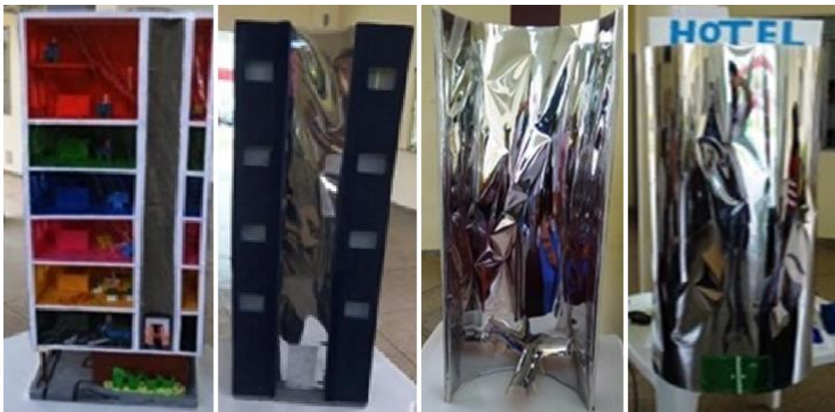
Figura 2: Maquetes construídas pelos estudantes - Da esquerda para direita: Fachada Plana Transparente; Espelhada Plana; Espelhada Côncava e Espelhada Convexa.
