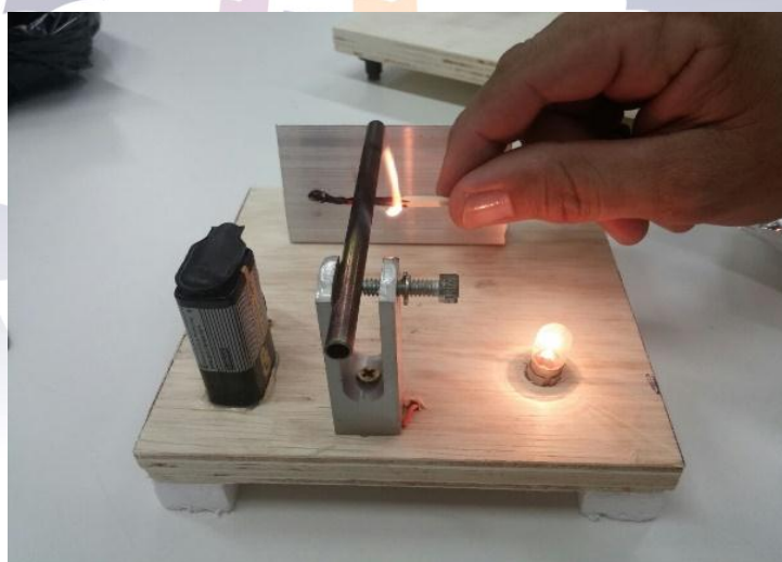
Figura 1: Experimento1 – Ao dilatar, a barra de alumínio empurra a barreira e acende uma lâmpada de Led.
