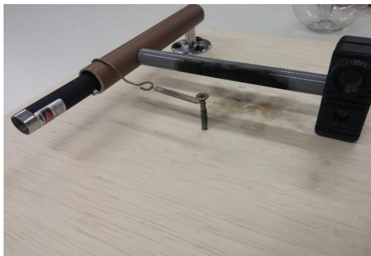
Figura 2: Experimento 2 – Ao dilatar, a barra de ferro mostra a luz de um laser se movendo.
