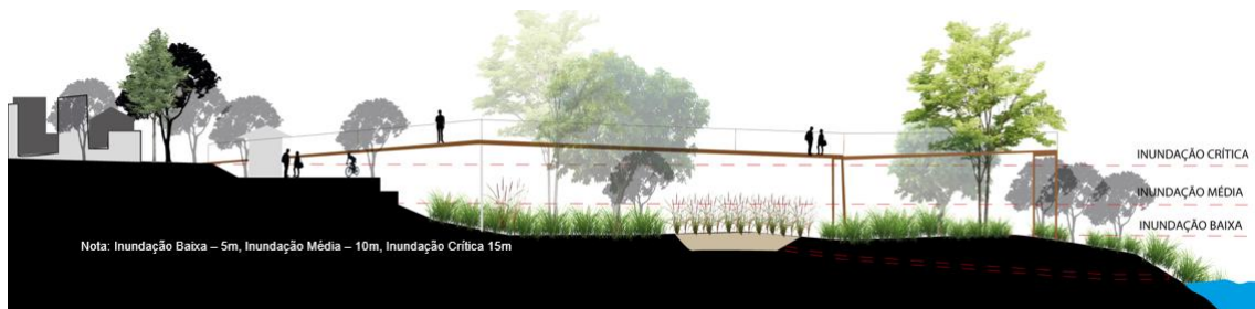
Figura 9 – Perfil esquemático de inundação do parque
