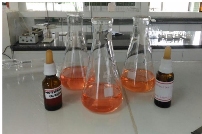
Figura 2. Alcalinidade pelo metodo de titulação com ácido clorídrico a 0,1N.
