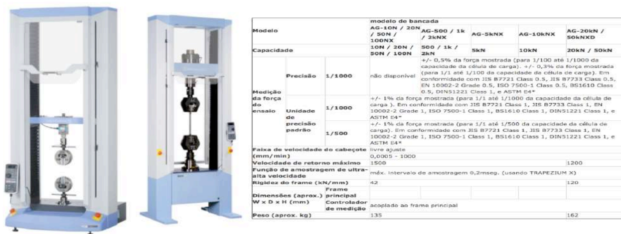
Figura 2. Máquina de tração: AGS-X– Especificações Técnicas.
