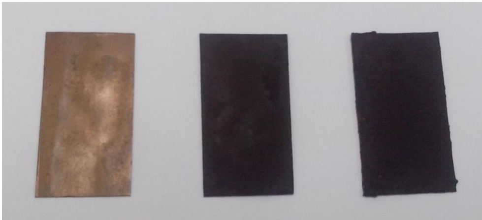
Figura 2. Substrato de cobre após deposição do geopolímero.
