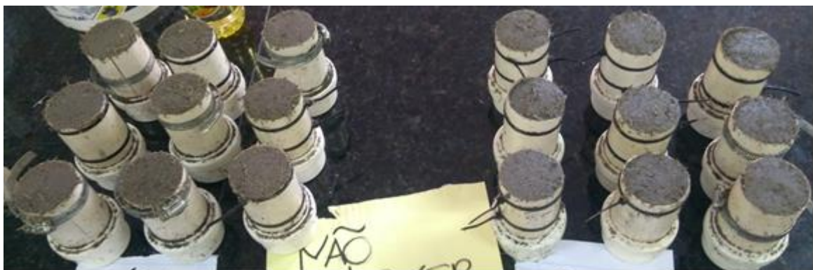
Figura 3- Corpos de prova de argamassa em moldes de PVC
