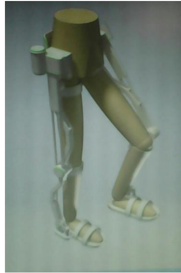
Figura 3. Prototipagem gráfica do dispositivo de simulação da marcha senil
