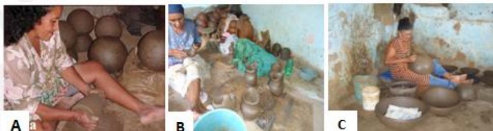
Figura 2. Produção das peças; a) Início da modelagem; b) formação das peças; c) acabamento.
