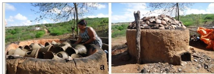
Figura 03. (a) Loiceira organizando as peças no forno (b) Forno cheio com as peças de barro e coberto com cacos de panelas quebradas, pronto para a cocção das “loiças”.
