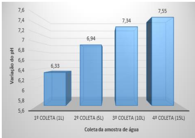
Gráfico 1-A. Variação do pH em função do volume de filtrado.
