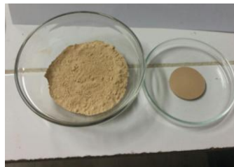
Figura 1. Membrana inorgânica (SPMI) preparada a partir da argila Bofe.
