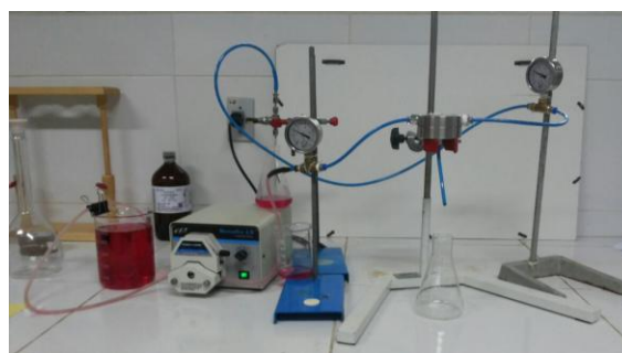
Figura 4. Sistema de separação por membrana inorgânica (SPMI) .
