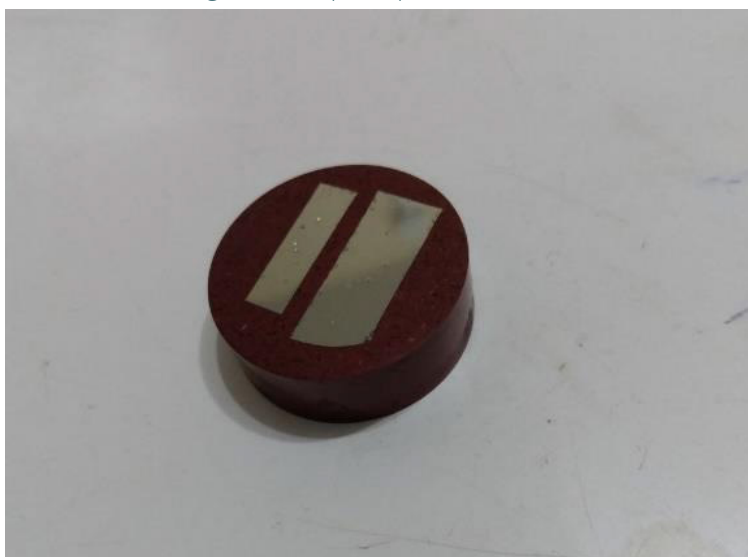
Figura 1: Corpo de prova embutido.
