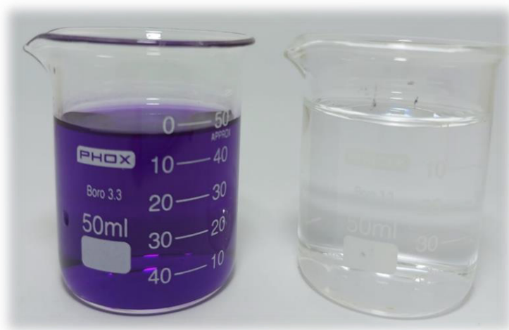
Figura 10 - Solução inicial do corante violeta cristal utilizado na alimentação com concentração de 50 \text{ mg}\cdot\text{L}^{-1} e o permeado coletado, após processo de separação por membrana em 5 mim de processo.
