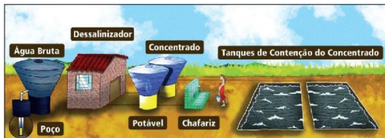
Figura 4.Representação esquemática do sistema de dessalinização adotado pelo Projeto.
