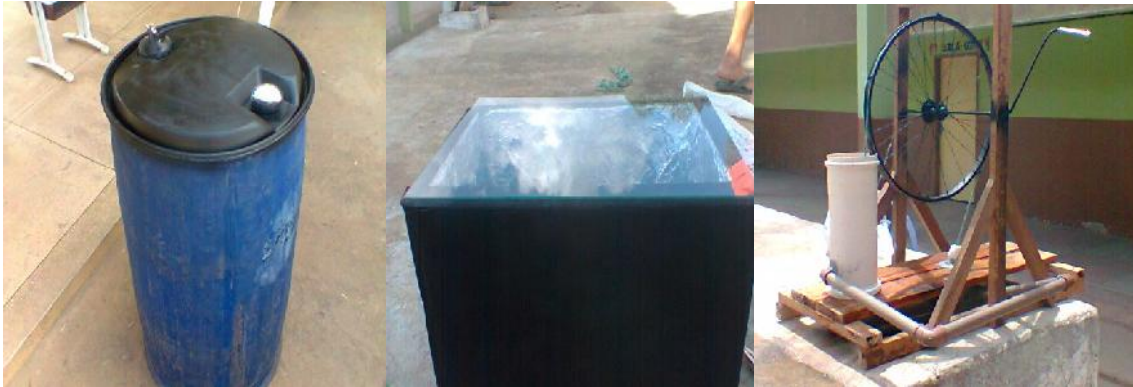
Figura 3: Biodigestor anaeróbico, forno solar e bomba de corda, respectivamente.
