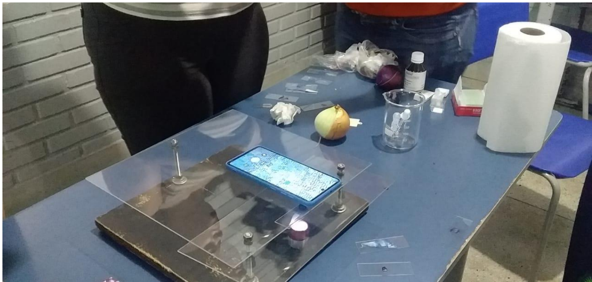
Figura 1- Microscópio caseiro e materiais utilizados em regência.
