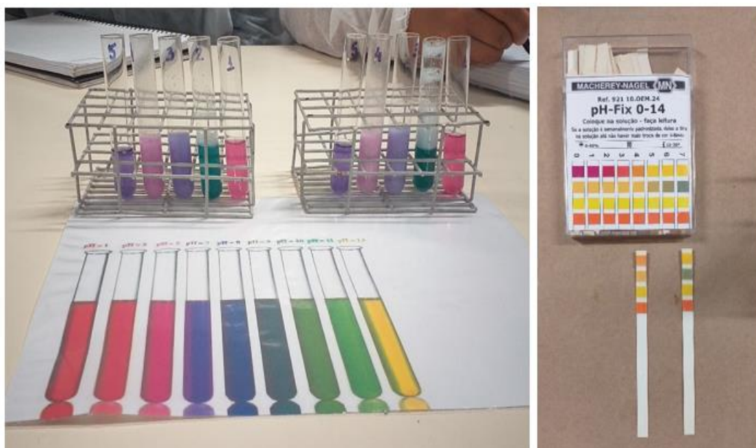
Figura 3. Experimento utilizando o indicador natural de valor de pH (esquerda) e comprovação com utilização de fita indicadora de valor de pH (direita).
