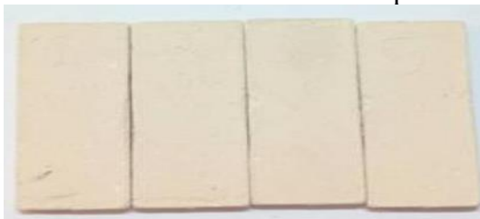
Figura 3: Massa cerâmica sinterizada na temperatura de 1075°C.
