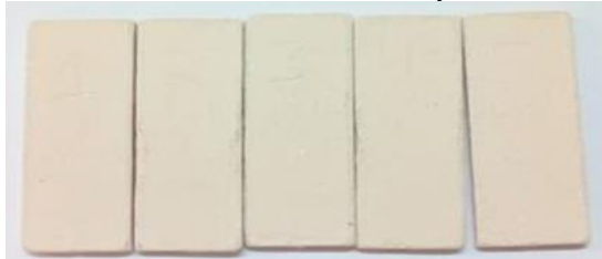
Figura 2: Massa cerâmica sinterizada na temperatura de 1000°C.
