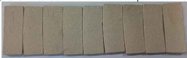
Figura 4: Massa cerâmica sinterizada na temperatura de 1150°C.
