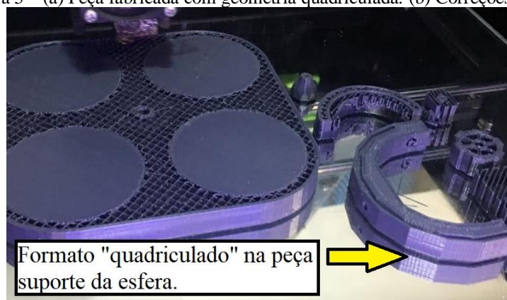
Figura 5 – (a) Peça fabricada com geometria quadriculada. (b) Correções feitas.
