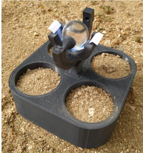
Figura 8 – Protótipo do heliógrafo montado e realizando uma prova de conceito.
