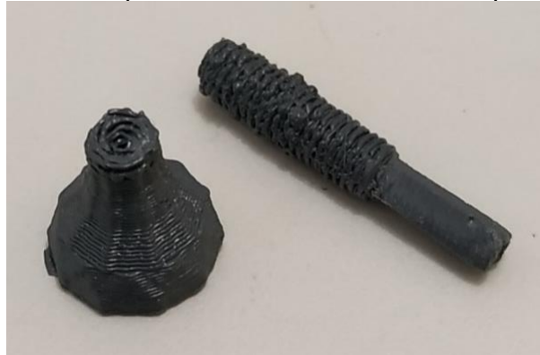
Figura 7 – Fixador móvel rompido em virtude do seu tamanho e seu preenchimento de 30%.
