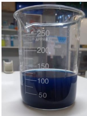
Figura 1: Efluente contendo corante Blue BlackLeve 303 , coletado de uma lavanderia de Toritama, município do Estado de Pernambuco, Brasil.
