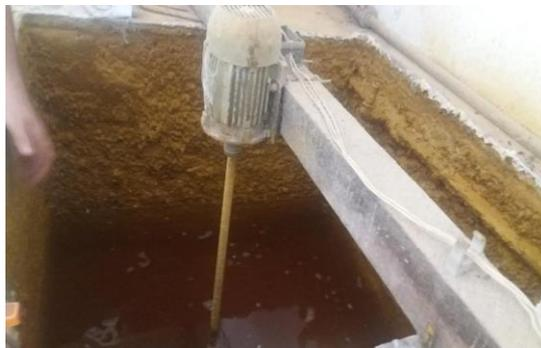
Figura 2: Motor aonde acontece a mistura do sulfato de alumínio
