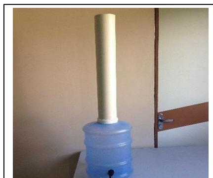
Com o objetivo de avaliar separadamente a eficiência do filtro lento no tratamento da água, foi realizado ensaio de tempo de vazão.
