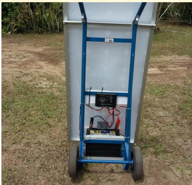
Figura 2 - Visão traseira do KLM, onde é visível o controlador de carga e a bateria.
