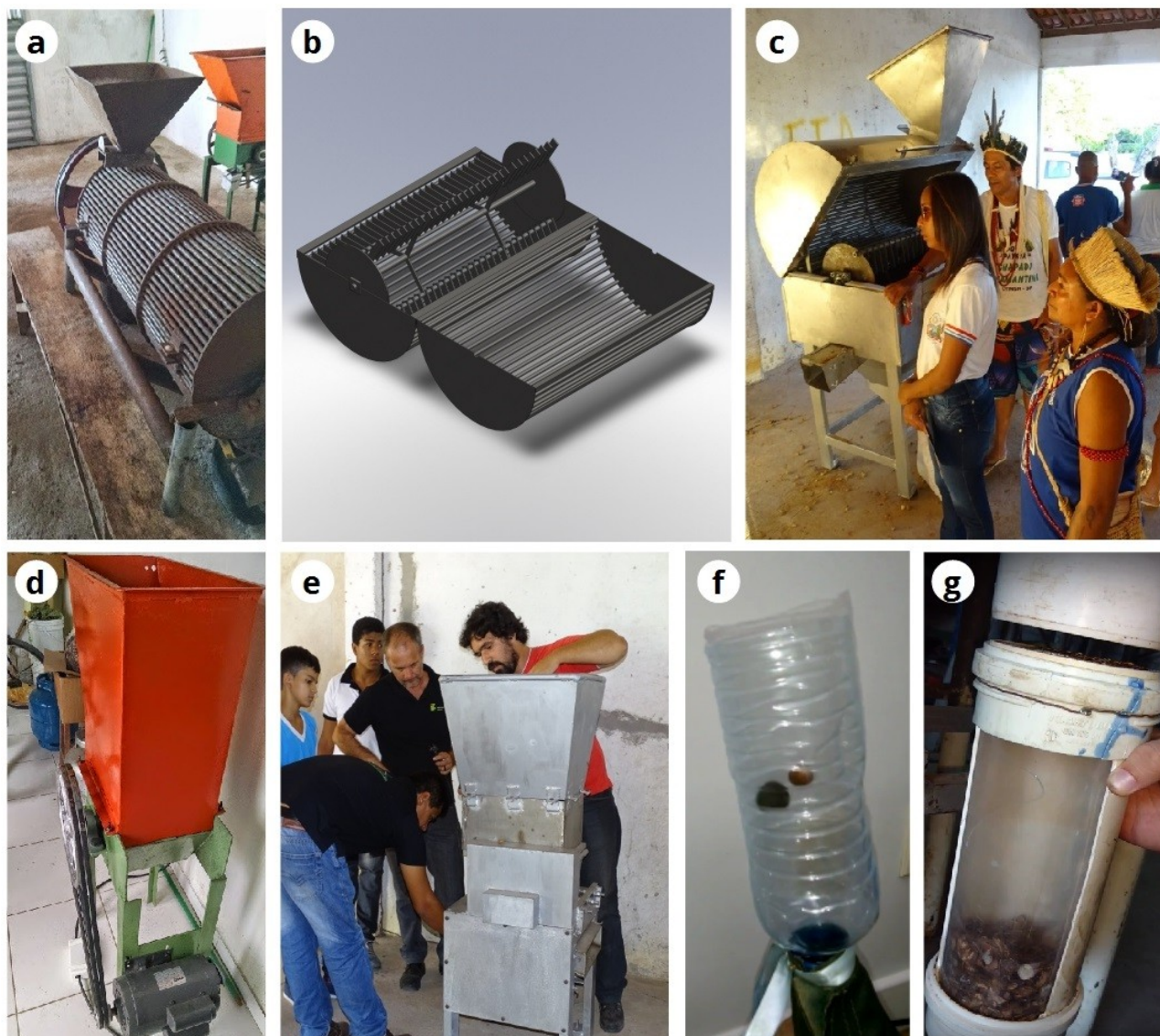
Figura 3. Protótipos e máquinas beneficiadoras de licuri: máquina despeladeira – original (a) e protótipo (b, c) testado com sucesso na 9ª Festa do Licuri (junho 2016, Quixabeira – BA); máquina quebradeira – original (d) (Comunidade de Caixão, Cansanção – BA) e protótipo (e) testados com alunos da EFA Jaboticaba (junho 2016, Quixabeira – BA); testes de separação a seco (f, g).
