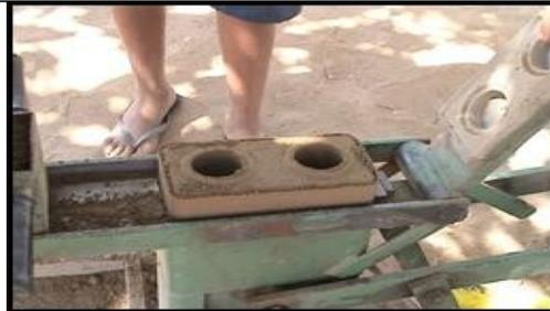
**Foto 08:** Retirada do tijolo da prensa manual
