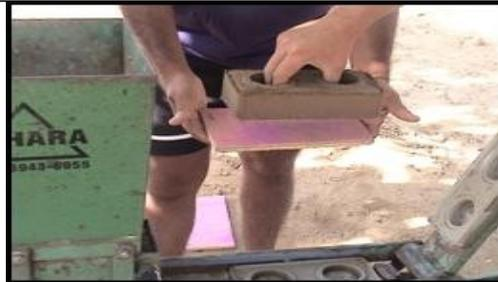
**Foto 10:** Teste de consistência do tijolo recém tirado da prensa manual
