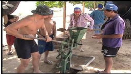
**Foto 09:** Produção dos tijolo de solo-cimento com prensa manual
