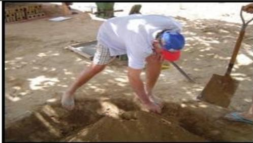
**Foto 07:** Teste para saber a umidade ótima da mistura
