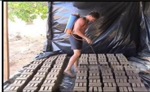
**Foto 12:** Otimização com água para auxiliar o processo de cura
