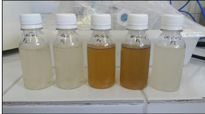
Figura 3. Nível de turbidez apresentado nas amostras de efluente tratado. Fonte: Autores (2016).
