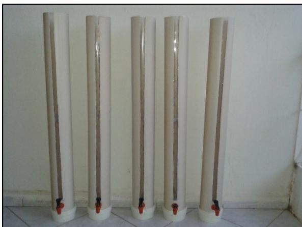
Figura 1. Fabricação dos filtros utilizando tubo de PVC de 100 mm. Fonte: Autores (2016).
