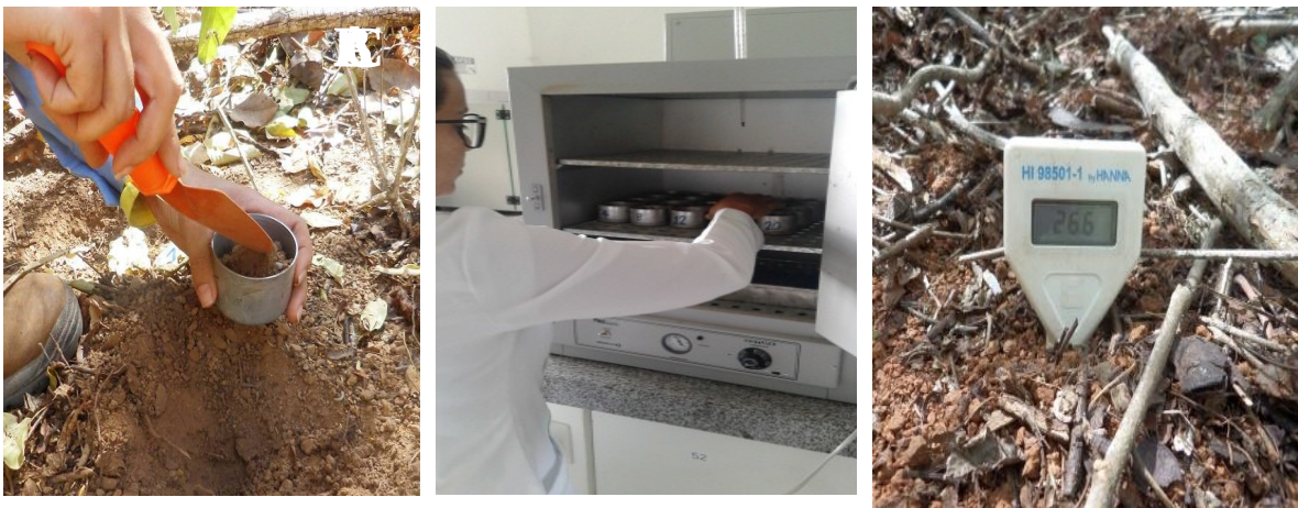
Figura 2. Coleta de solo para determinação de conteúdo de água do solo orgânica (A), Solo sendo levado para estufa (B), Medição da temperatura do solo com termômetro tipo espeto (C).
